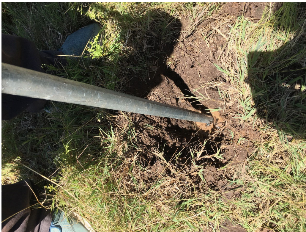
Figura 18: Pozo inundado mientras se intenta obtener la muestra de suelo de 1m de profundidad.
