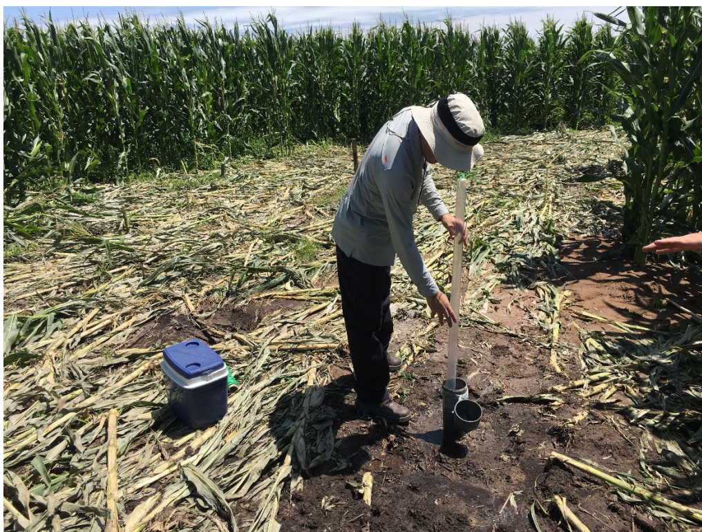
Figura 25: Freatímetro F3 ubicado en el vértice NO del predio SIP. Se observa en la imagen el bailer de muestreo.
